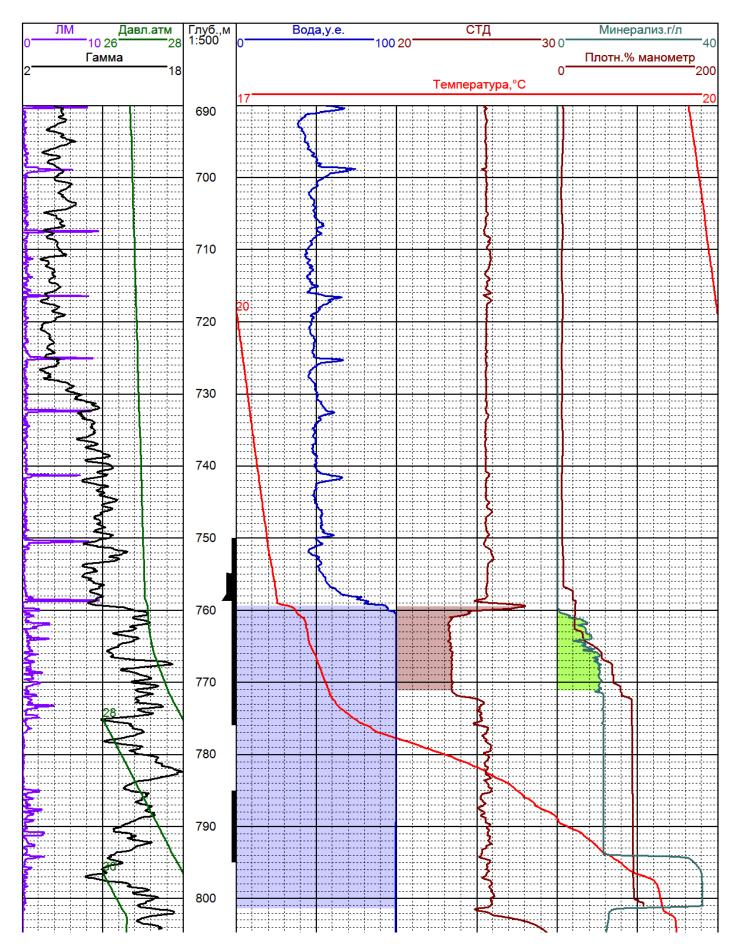
Комплексный замер (одновременно со спектральным шумомером). Синим цветом отмечен интервал, заполненный водой, коричневым и зелёным — интервал поступления газа по данным СТД и резистивиметра соответственно.
