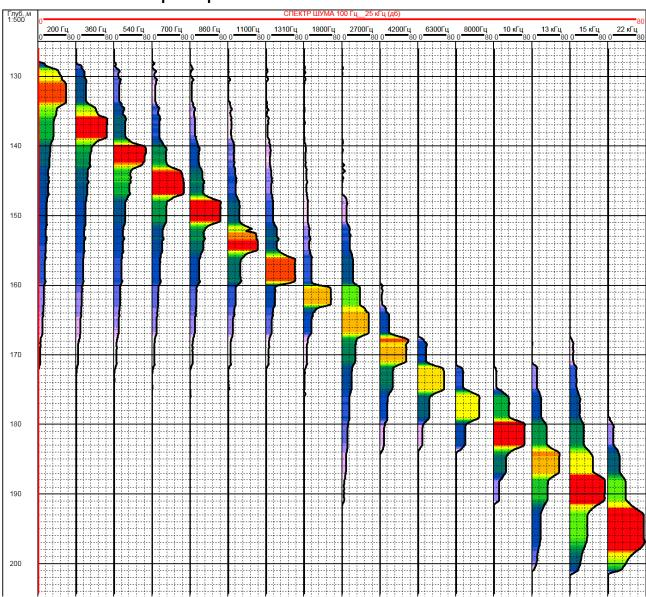
На рисунке представлен планшет, иллюстрирущий вид ампитудно-частотной характеристики (АЧХ) 16-ти полосного фильтра. Данные получены при непрерывном изменении частоты подключенного ко входу генератора в диапазоне 100...25000 Гц, регистратор включен в режиме имитации движения прибора.
