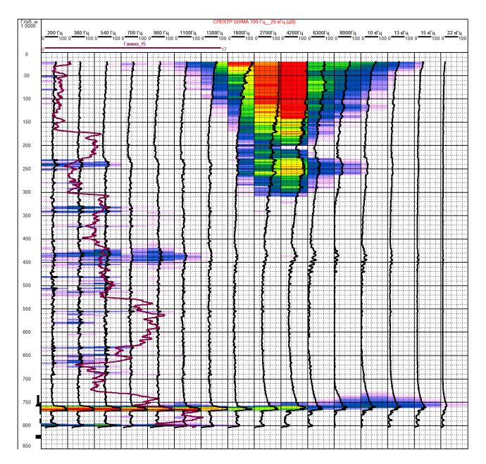
Замер спектральным шумомером на подъёме V= 660 м/ч (обзорный планшет). Аномально высокий уровень среднечастотных шумов в верхней части скважины связан с фильтрацией газа в околоскважинном пространстве. Наличие грифона наблюдалось визуально на устье скважины. Такое явление отмечено в двух из трёх исследованных скважин.
