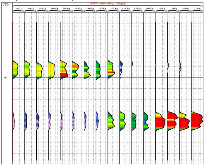
На рисунке представлен планшет, на котором показана реакция прибора на шум в лабораторных условиях. Шум имитировался простейшим образом путём лёгкого «шуршания» ножом по корпусу прибора. Вначале использовалась пластмассовая рукоятка ножа и получен спектр низкочастотных шумов примерно до 3 кГц с максимумом в районе 860 Гц. Затем та же операция, но уже лезвием ножа. В этом случае основной частотный диапазон от 2700 до 25000 Гц с максимумом в области 10 кГц и выше.
