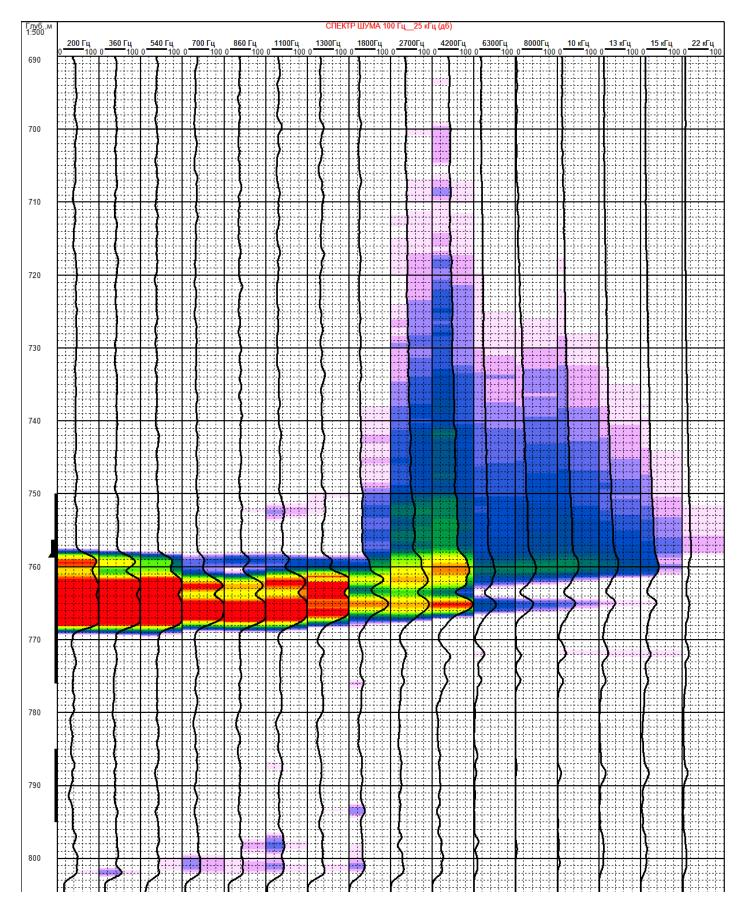
Замер спектральным шумомером на спуске V= 370 м/ч. Наиболее интенсивный уровень шумов наблюдается в интервале поступления газа в воду (барботаж) ниже приёма НКТ в диапазоне низких частот до 1 кГц. Шум в диапазоне средних и высоких частот 2,7\_\_ 15 кгц, видимо, обусловлен фильтрацией газа в пласте выше перфорации.
