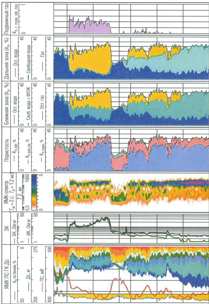
Рис. 5. Пример оценки насыщенности газовой залежи с переходной зоной с использованием данных ЯМК в комплексе ГИС (сеноман, Западная Сибирь)
