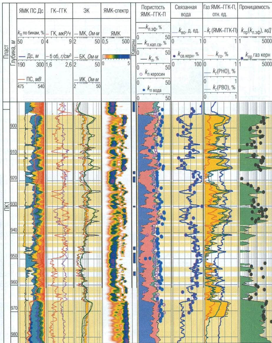
Рис. 4. Сопоставление результатов обработки ЯМК-ГГК-П с данными керна
