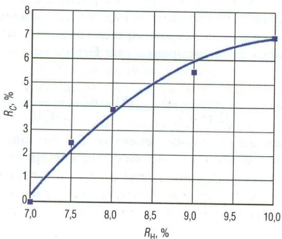
Рис. 4. Зависимость дополнительного кажущегося разрешения  $R_C$ , которое необходимо наложить на аппаратурный спектр с начальным разрешением 7% по водороду для получения спектра с разрешением  $R_H$
