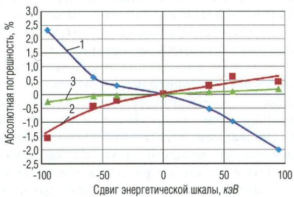
Рис. 2. Абсолютная погрешность определения массовых содержаний элементов, обусловленная несогласованностью энергетических шкал исследуемого и модельных спектров. Сдвиг энергетической шкалы указан для линии железа 7650 кэВ:
