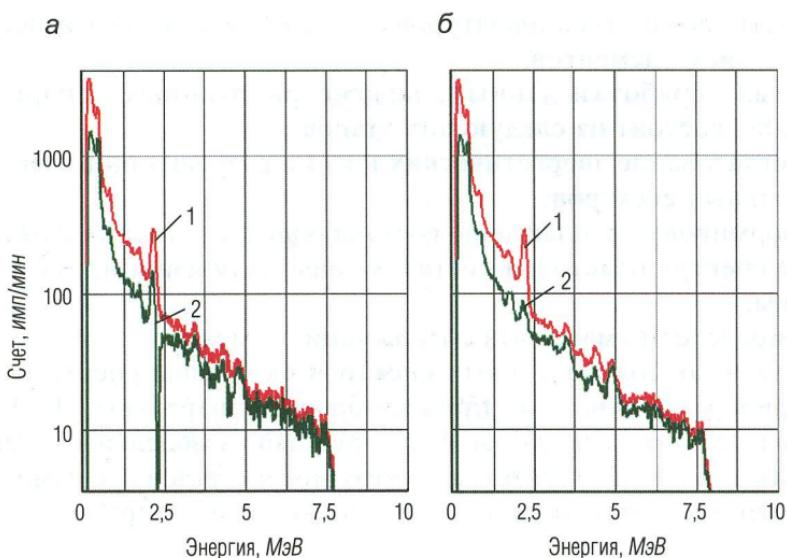
Рис. 1. Влияние несогласованности энергетического разрешения на корректность выделения пластовой составляющей регистрируемого спектра:
