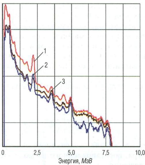
Рис. 8. Влияние минерализации раствора на корректность выделения пластовой составляющей ( $d_c = 216$  мм,  $\sigma_{\text{пж}} = 1,00$  г/см $^3$ ,  $C_{\text{пж}} = 0$  г/л NaCl):
