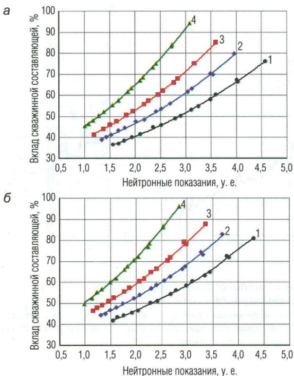
Рис. 6. Зависимость вклада излучения скважины в спектр аппаратуры СНГК-89 от технических условий измерений:
