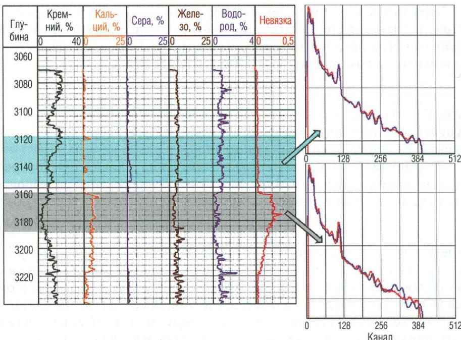
Рис. 9. Зависимость коэффициента невязки от согласованности энергетических шкал спектров
