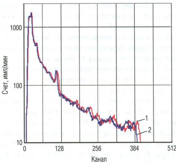
Рис. 3. Изменение энергетической шкалы в процессе каротажа:
