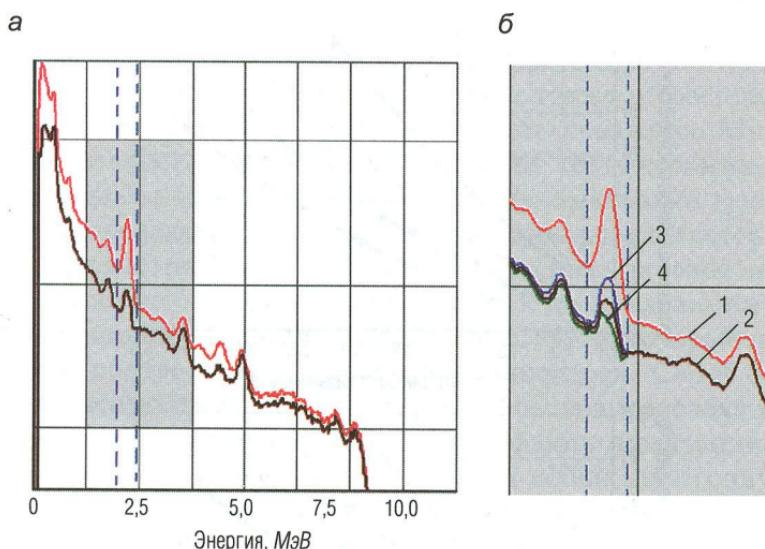
Рис. 7. Влияние номинального диаметра скважины на результат выделения пластовой составляющей ( $d_c = 216$  мм,  $\sigma_{\text{пж}} = 1,16$  г/см $^3$ ,  $C_{\text{пж}} = 0$  г/л NaCl): 1 – полный зарегистрированный спектр; 2 – спектр пластовой составляющей излучения; 3 – спектр пластовой составляющей излучения при  $d_c = 226$  мм; 4 – спектр пластовой составляющей излучения при  $d_c = 206$  мм
