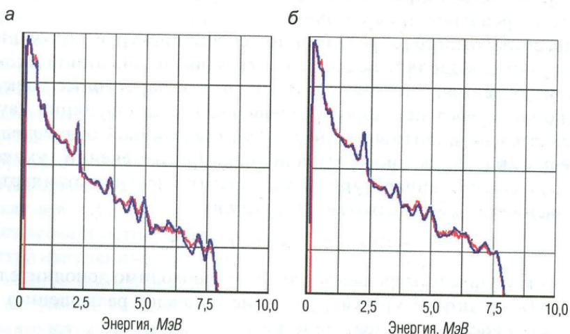
Рис. 5. Измеренный (красный) и восстановленный (синий) спектры СНГК-89 до и после согласования энергетического разрешения
