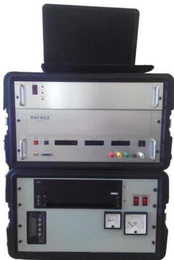
Регистратор КАСКАД-2 состоит из двух модулей, установленных в прочном корпусе. Верхний модуль имеет панель управления с дисплеем и кнопками. Нижний модуль содержит аналоговые измерительные приборы и переключатели.
