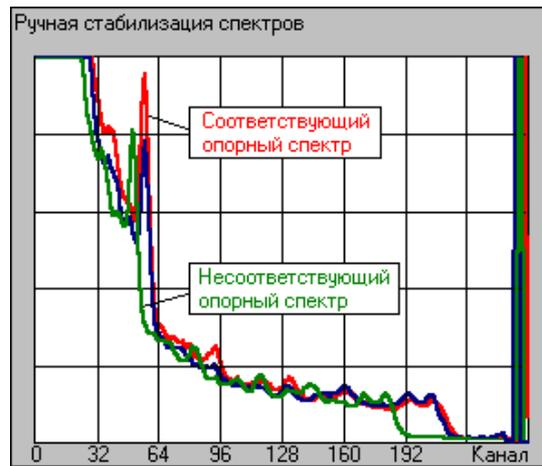
**Рисунок 6.11. Пример сопоставления опорного спектра скважинным данным**
