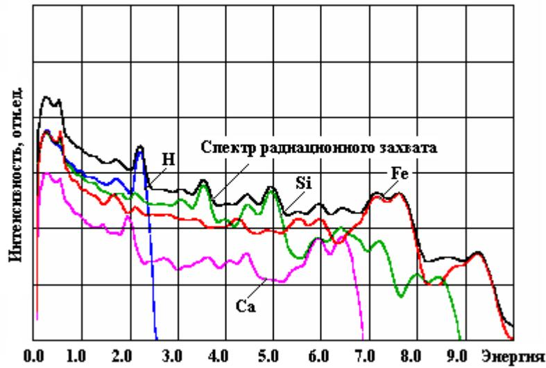
**Рисунок 1.4. Пример формирования аппаратных спектров радиационного захвата нейтронов из спектров отдельных элементов**
