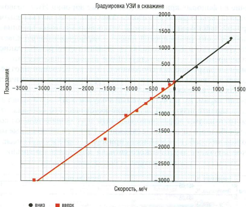
Рис. 2. Градуировочная характеристика ультразвукового расходомера, полученная в скважине при разных скоростях движения прибора
