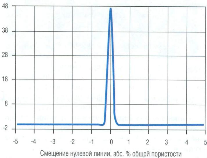
Рис. 3. Гистограмма смещения нулевой линии прибора серии ЯМТК
