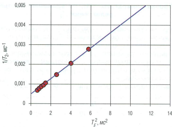
Рис. 4. Зависимость для определения градиента магнитного поля
