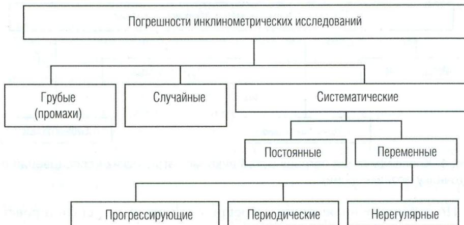
Рис. 2. Классификация погрешностей инклинометрических исследований по характеру проявления
