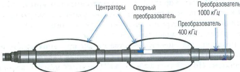
Рис. 3. Конструкция прибора ACT-K-80-120/80
