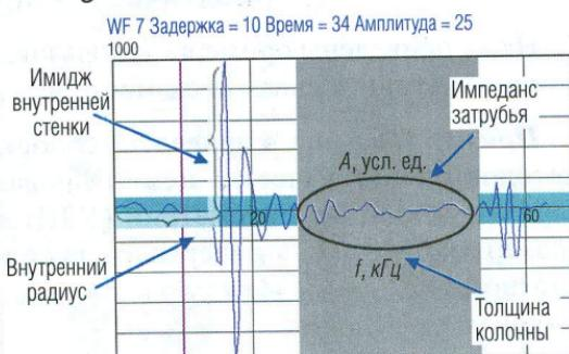
Рис. 2. Вид акустического сигнала: а – в интервале свободной колонны; б – в интервале зацементированного участка. В интервале свободной колонны амплитуды в окне реверберации (серый цвет) максимальны, в отличие от зацементированного участка
