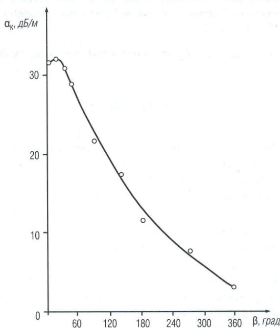
Рис. 6. Зависимость коэффициента затухания  $\alpha_k$  от угла раскрытия вертикального канала в бездефектном цементном кольце плотностью  $1,85 \text{ г}/\text{см}^3$  [6]. Значение  $\alpha_k$ , равное границе между сплошным и частичным контактами, соответствует углу раскрытия  $60^\circ$ .
