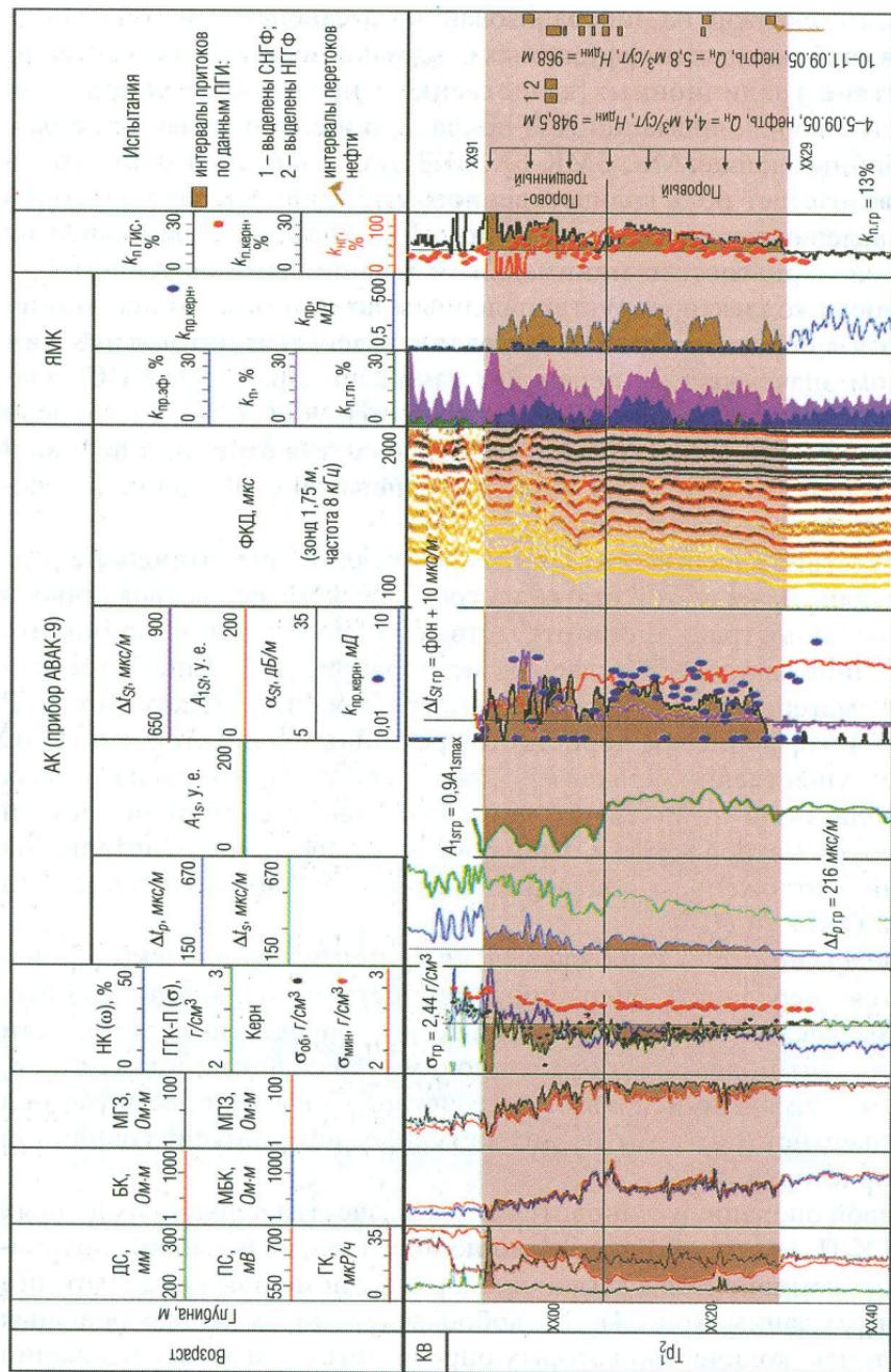
Рис. 2. Выделение и количественная оценка порового и порово-трещинного коллекторов по данным ГИС в эзфузивном разрезе. Скважина Рогожниковского месторождения
