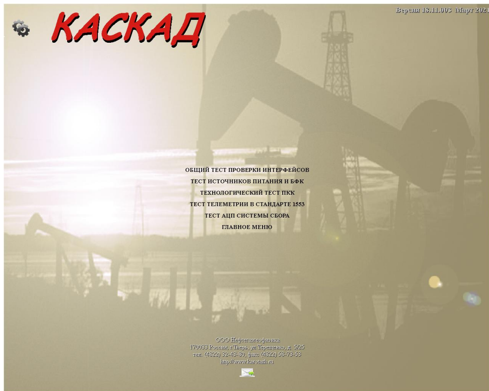
Рисунок 2.3.2. Пункты меню «Тестирование оборудования» при включенной системе измерения глубин ПКК-FTDI для версий регистратора КАСКАД 1/2/3
