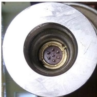
**ВНИМАНИЕ!** Электрический соединитель имеет два паза различной глубины. Убедиться в том, что соединитель интерфейсного кабеля попал в нужный (более глубокий) паз!
